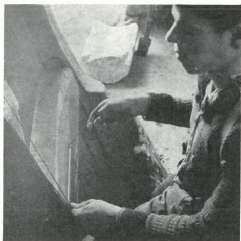
Fig. 7. Væveren i Færd med at skubbe Løkken nedefra ind over Jernstangen, D.
