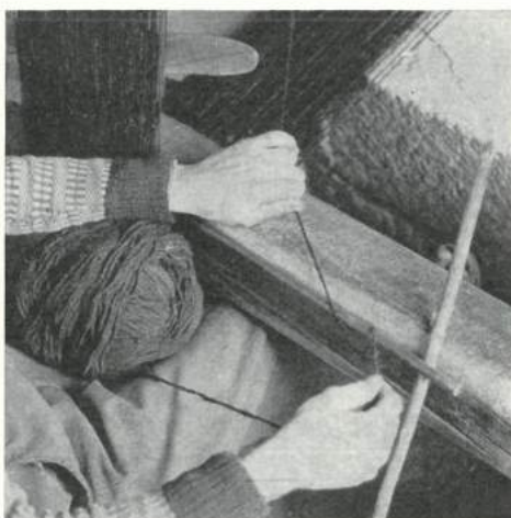
Fig. 8. Væveren har dannet en ny Løkke, men nu paa Traaden oppefra, og er i Færd med at skubbe denne ind over Jernstangen, D.
