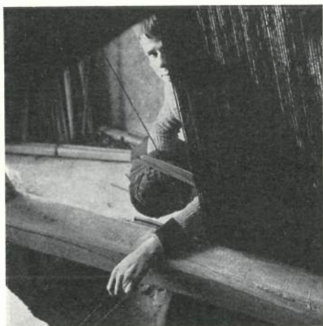
Fig. 5. Billedet viser, hvorledes Væveren med venstre Haand griber Løkken, som Drengen har ført frem til ham ved Hjælp af Trækrogen.
