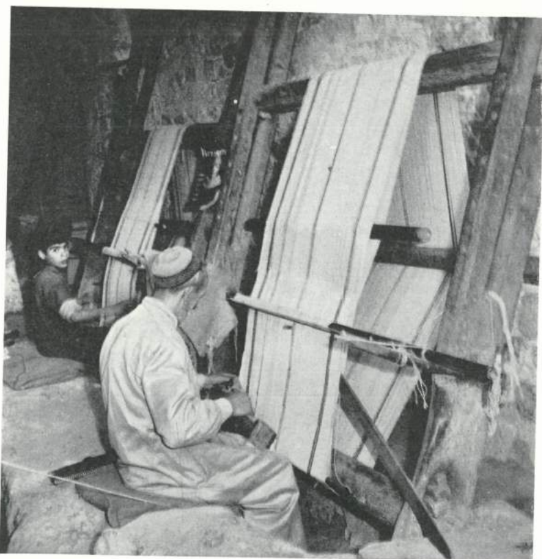
Fig. 60. Rundvæv, her med tre Bomme, samme Princip som de danske Jernalder-væve. Hama, Syrien 1961. M. Hald fot.
